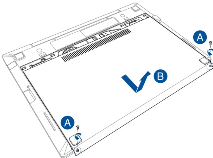
Para volver a acoplar la tapa del compartimento:
