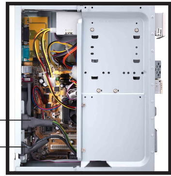
電源插座模組上的電源及電壓調整插座
