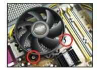
3. Connect the CPU fan cable.
