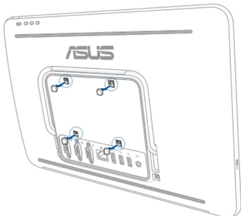
3. Placez les quatre vis fournies dans les pas de vis du panneau arrière.
